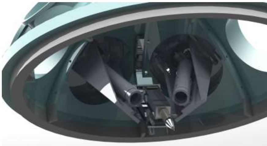
Dessin Solidworks de l'implantation de la sténopée
