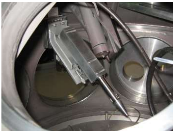
Photographie de la sténopée implantée dans l'enceinte d'ELFIE.
