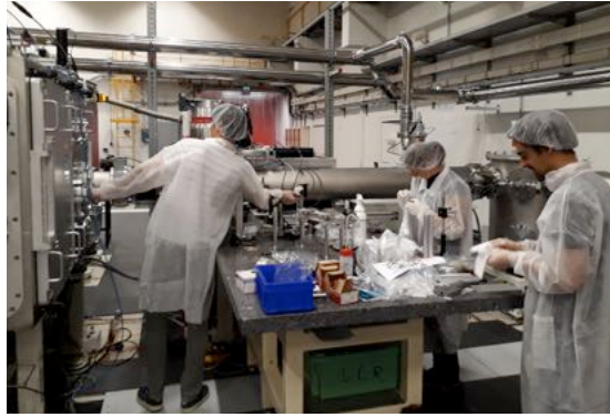
A gauche : installation du spectromètre ; au centre : installation des diagnostics plasma ; à droite : absorbeur faisceau
