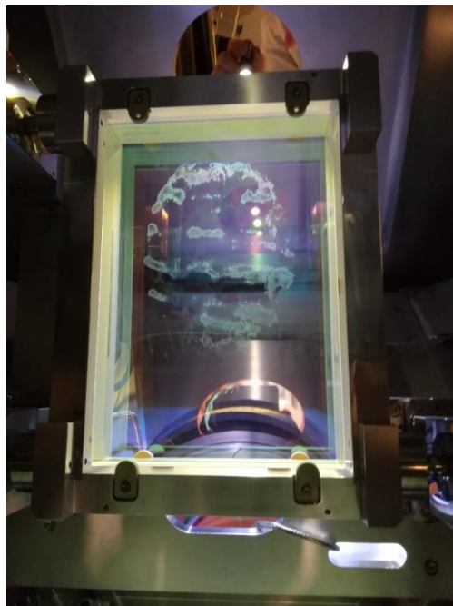
Endommagements du miroir à fuite en sortie compresseur
